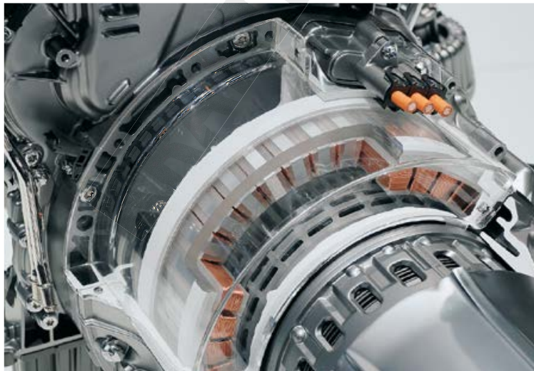
4.1 Längs oder quer eingebaut: Bei klassischen Parallelhybriden befindet sich der Elektromotor typischerweise zwischen Verbrennungsmotor und Getriebe.
